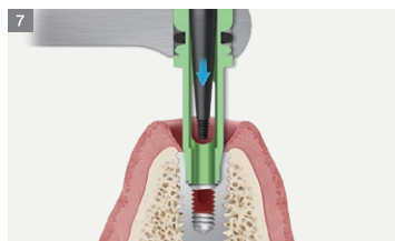
Зафиксировать Инструмент для удаления винта (SR-Tip) в Направителе
